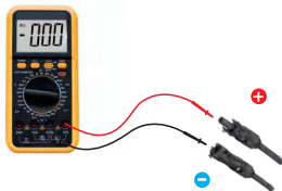
Figura 3.22 Medição de multímetro
