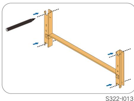
**Passo 3** Insira os parafusos de expansão nos furos e prenda-os com um martelo de borracha. Aperte a porca com uma chave para expandir o parafuso. Remova a porca, a arruela de pressão e a arruela plana e guarde-as corretamente.
