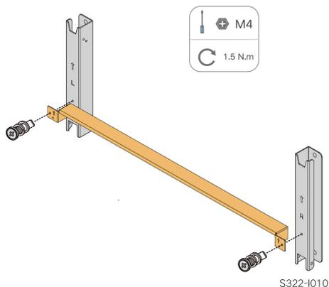
**Passo 2** Nivele o suporte de montagem montado usando o nível e marque as posições dos furos no local da instalação.
