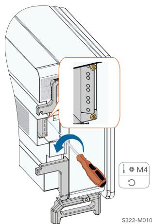
**Passo 5** Tire os ventiladores. Limpe os ventiladores com uma escova macia ou um aspirador de pó, e substitua-os quando for necessário.
