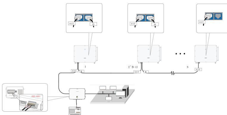
**Figura 5-7** Sistema de comunicação com múltiplos inversores 【Interface RS485\_1 (RJ45)】
