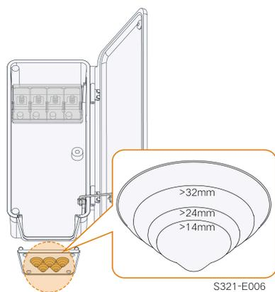
**Passo 5** Passe o cabo pelo anel de vedação e aperte os parafusos na placa de vedação inferior.
