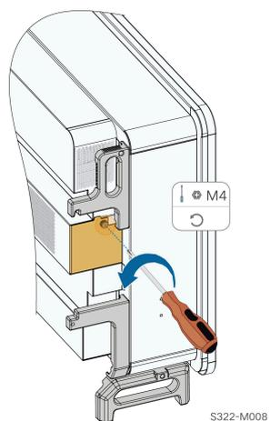
**Passo 3** Pressione a protuberância do gancho de trava, desconecte a junta de conexão do cabo para fora e solte o parafuso no suporte do ventilador.
