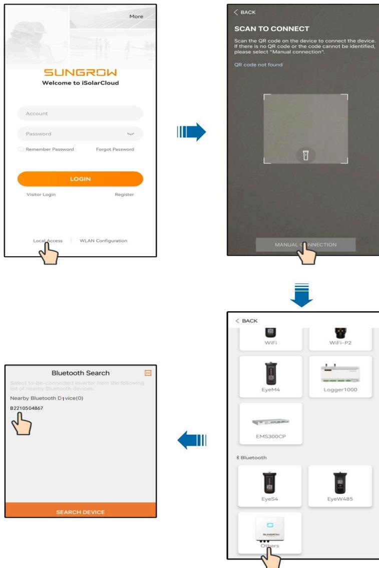
Figura 7-1 Conexão Bluetooth
