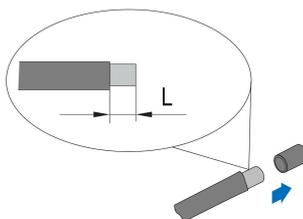
**Passo 2** Crimpe as extremidades dos cabos utilizando alicates apropriados.
