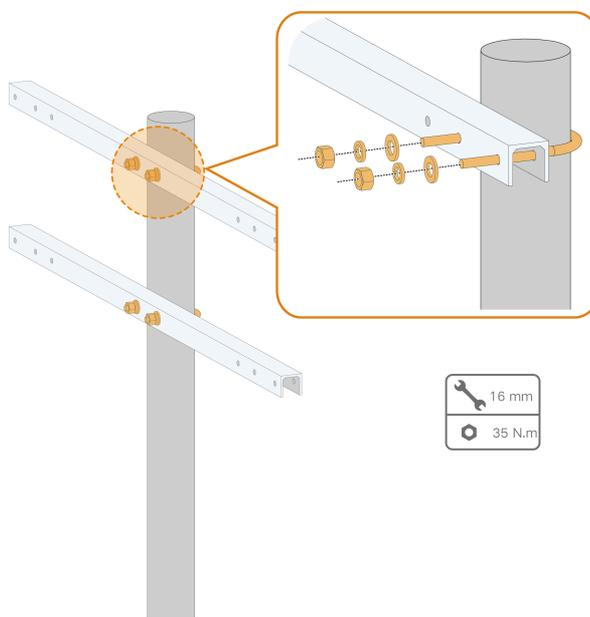
**Passo 5** Use parafusos para fixar a placa perfurada na viga em U.
