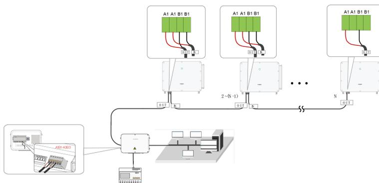
**Figura 5-6** Sistema de comunicação com múltiplos inversores 【Interface RS485\_1 (bloco de terminais)】
