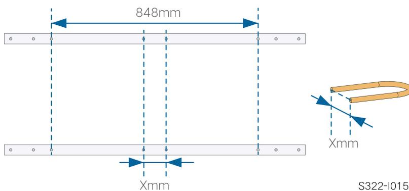
**Passo 4** Use parafusos e grampos para fixar a viga em U à coluna.
