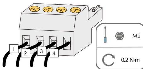
**Passo 6** Insira o soquete do terminal no bloco de terminais correspondente.
