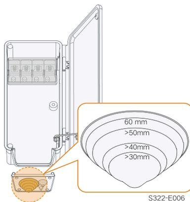
**Passo 5** Passe o trecho desencapado do cabo pelo anel de vedação e aperte os parafusos na placa de vedação inferior.
